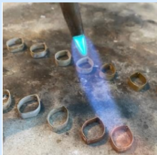
soldering flux-covered bezels
